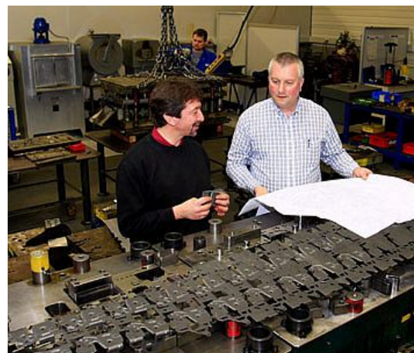
Mit 630 Tonnen Kraft arbeitet diese riesige Stanze bei N.I.E.R. - im Vordergrund (von rechts nach links) Werksleiter Peter Gehre mit den Mitarbeitern Dirk Saure und Alessandro Ragona - und produziert (Bild rechts) unablässig Schlosskästen. © Fotos: Roland Keusch
